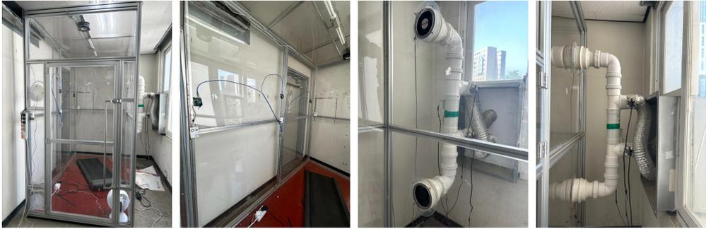
Fig. 14. Mock-up 구축 및 센서, 환기시스템 설치
